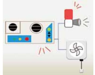
リレー無電圧接点搭載により、回転灯や大型サイレン、電磁弁などの外部出力に対応。あらゆる顧客ニーズを叶えます。
